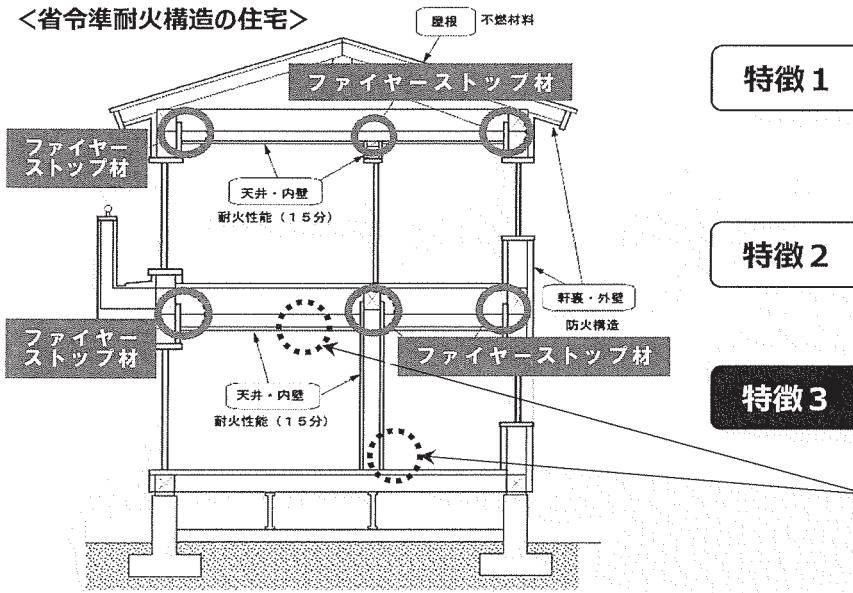
(注) 開口部に防火設備を設置する必要なし。床は制約なし。
